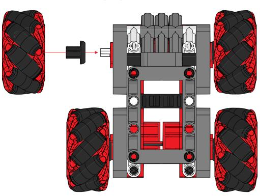
轮子必须按照装配图 所给方向安装,否则 会导致小车出现移动 方向错误的情况。
